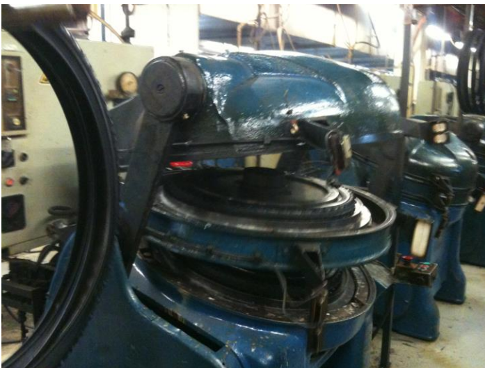
Prasy wulkanizacyjne. Jedna bez izolacji, druga z napyłoną warstwą AERO-THERM
